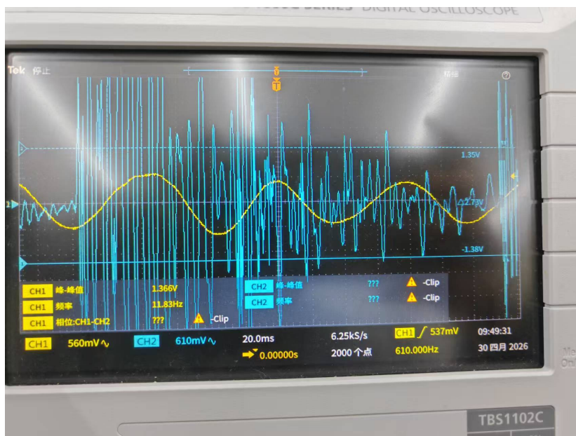
图 8.2 – 轻击试验台时的波形毛刺现象
